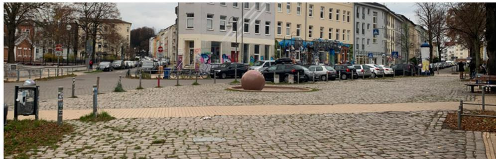
Abb. III 5 – Beispiel für optische und taktile Trennung von Verkehrsflächen unterschiedlicher Nutzung
