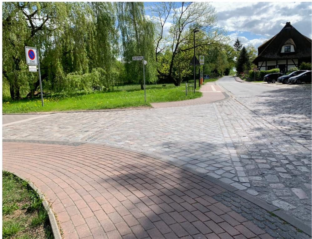
Abb. V 1 – Gehwegquerung mit geschnittenem Natursteinpflaster im Bereich einer Natursteinpflasterbefestigung
